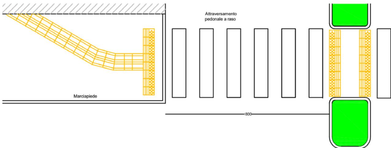
Le linee guida per la progettazione dei segnali e percorsi tattili necessari ai disabili visivi per il superamento delle barriere percettive di I.N.M.A.C.I. Istituto Nazionale per la Mobilità Autonoma di Ciechi ed Ipovedenti, indicano nella lunghezza di 8 metri la distanza oltre la quale la persona cieca non riesce a mantenere una traiettoria rettilinea senza la necessità di realizzare il percorso guida. Tenendo fede a questo dato sarà necessario, per
