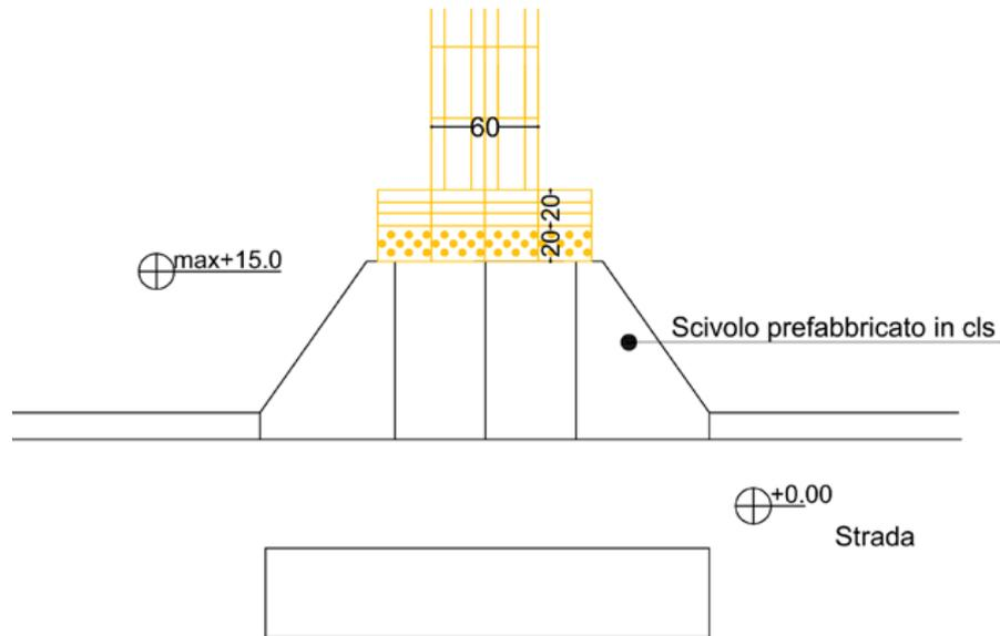
L'inserimento di uno scivolo prefabbricato infatti, mal si integra con la realizzazione del percorso pedotattile, che in caso di elemento prefabbricato deve arrestarsi all'inizio dello scivolo anzichè condurre il non-vedente sino alle strisce zebbrate, dettaglio che potrebbe acquisire ancor più rilievo in caso di incrocio regolato da semaforo.
