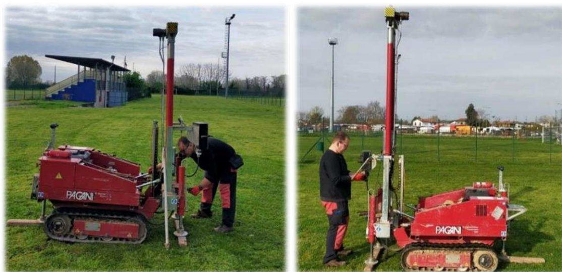
Figura 17: prove penetrometriche dinamiche DSPH
