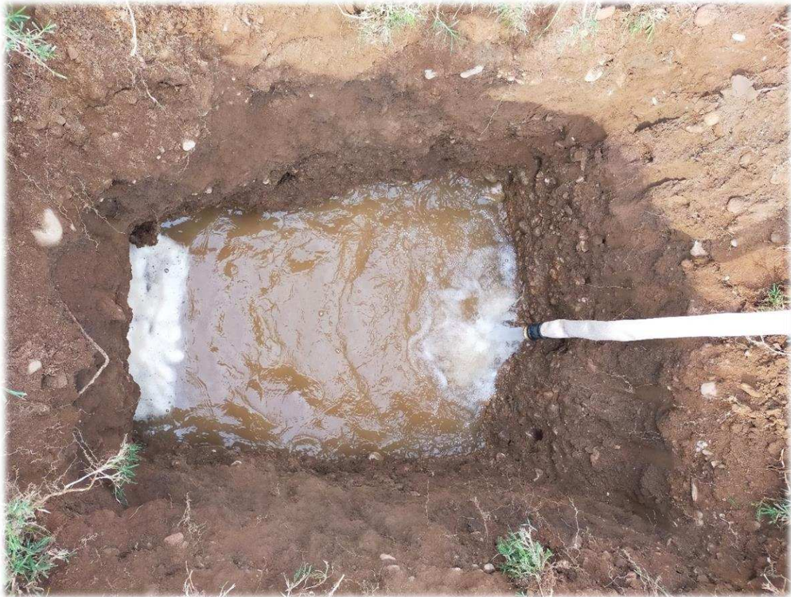
Figura 4: scavo esplorativo SE1 e prova di permeabilità PP1
