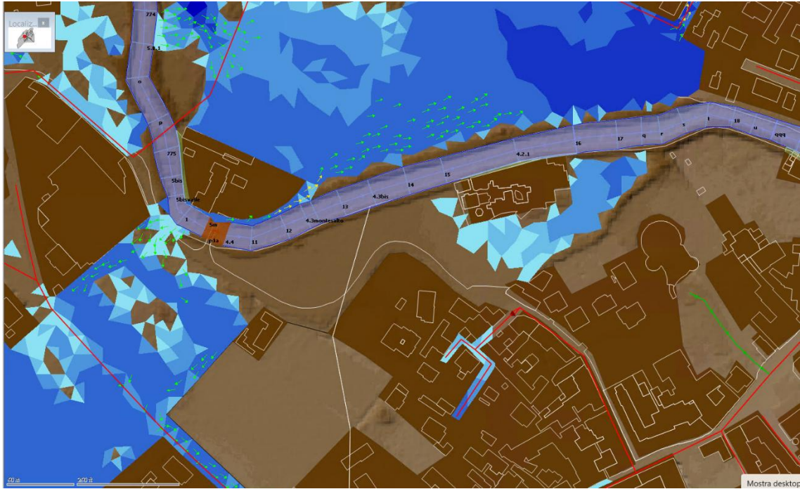
Figura 45 – Stralci del modello 2D-1D e dei risultati di simulazione, con evidenziate le maglie di calcolo e le particolarità costituite dalle zone di livello di magliatura (evidenziate nelle immagini dalle aree colore marrone scuro)
