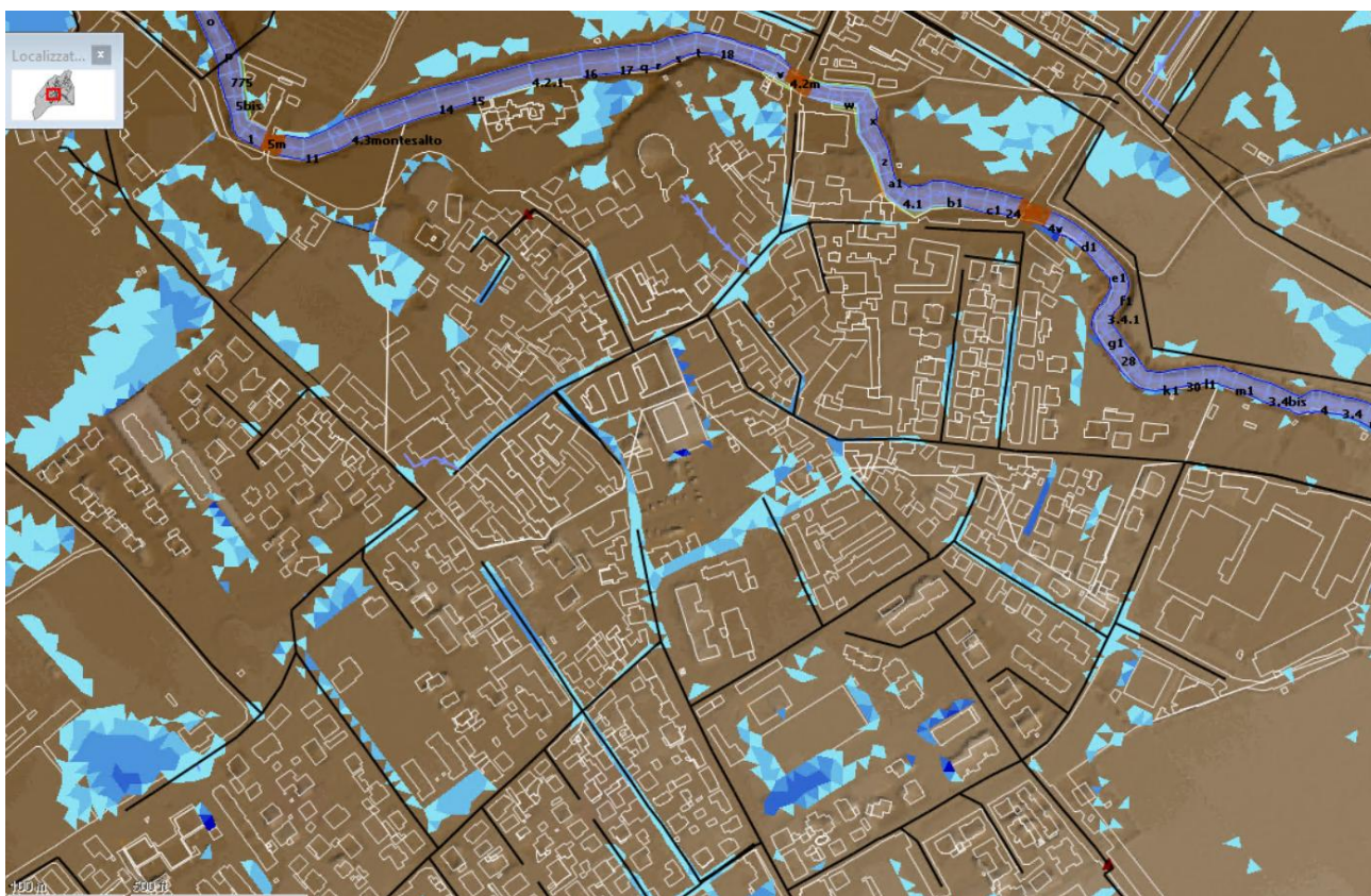
Figura 60 – Rappresentazione dell'involuppo dei massimi livelli idrici delle simulazioni T 10, P 10
