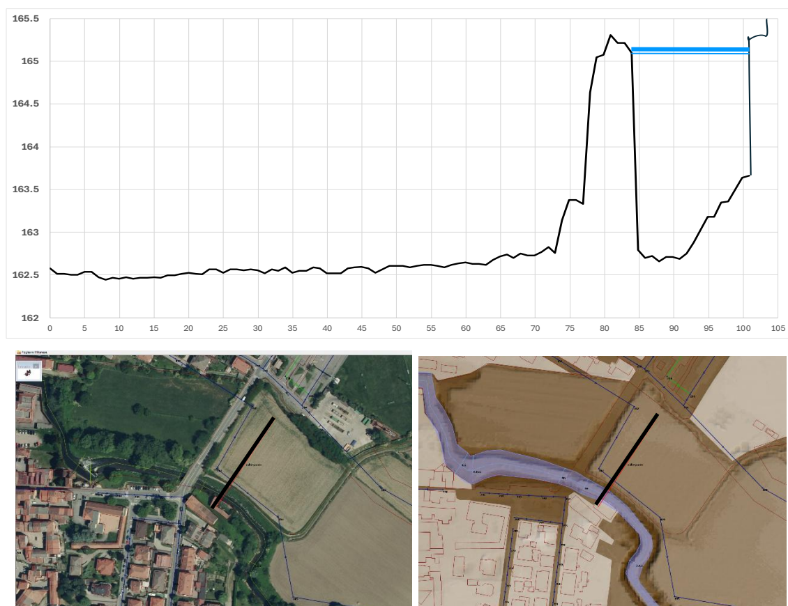
Figura 5 – Rappresentazione della sezione del terreno e del fiume Olona nella posizione e nella situazione della precedente Figura 4 (risulta molto evidente il livello idrico contenuto dagli argini, rispetto al piano campagna circostante). Nelle immagini sotto è evidenziata la posizione della sezione rappresentata
