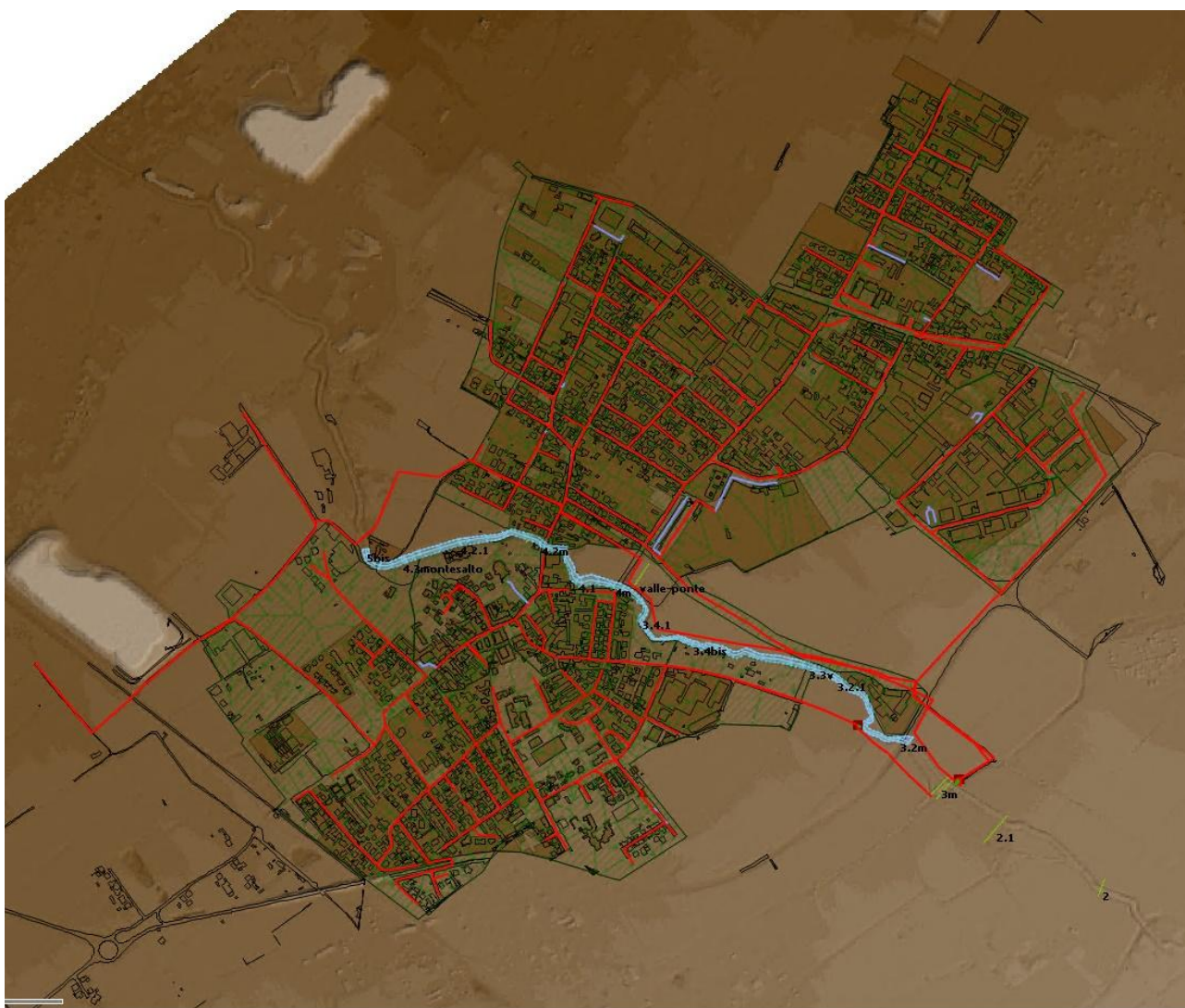
Figura 39 – Stralcio della planimetria del modello 2D InfoworksICM della superficie del territorio di Pogliano M.se e della sua rete fognaria (questa evidenziata in colore rosso nell'immagine) su base DTM 1x1
