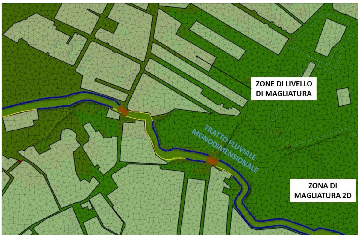
Figura 44 - Dominio 2D e zone di livello di magliatura
